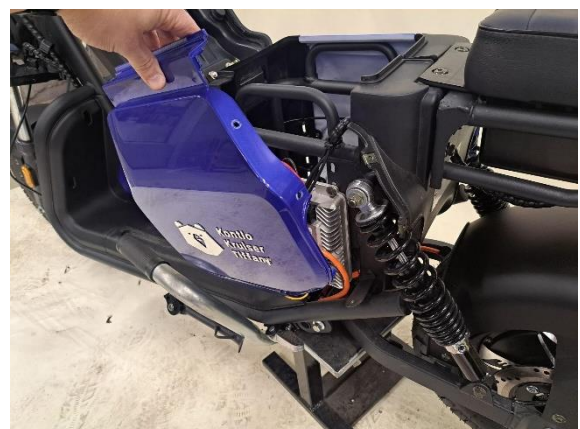
Ota istuimen vasemmanpuoleinen alasivumuovi pois.
