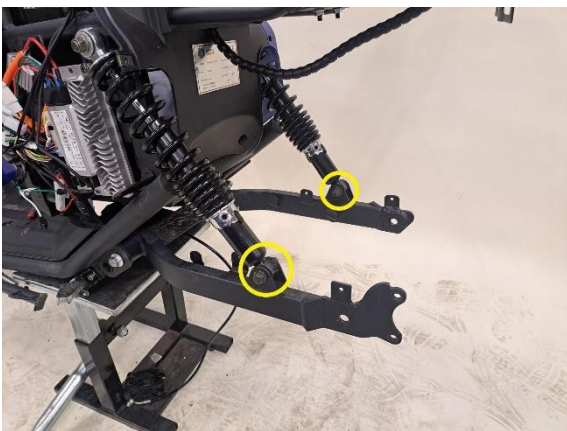
Irrota takajousien alapään kiinnityspultit takahaarukasta (kiintoavain 12 mm).
