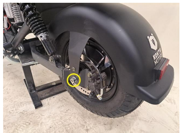
Irrota moottorin kiinnityspultit molemmin puolin (kuusiokoloavain 10 mm).
