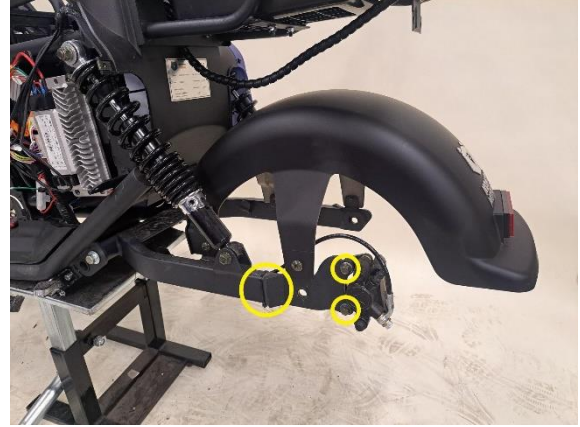
Irrota takajarrusatulan kiinnityspultit (kiintoavain 10 mm) ja katkaise takajarruletkeä takahaarukassa kiinni pitävä nippuside (sivuleikkurit).
